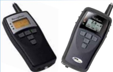
Bearingchecker (controlador de rodamientos)
